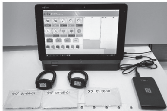
写真2 QRコード型・NFC型作業管理システム
