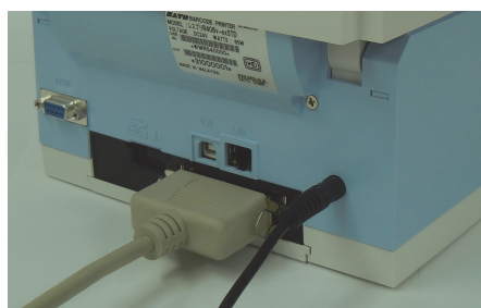
パラレルケーブル接続
